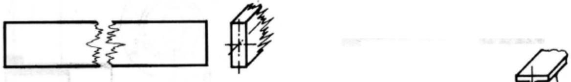
**Perfil laminado.** Se trazará con línea de trazo y punto estrecha.
