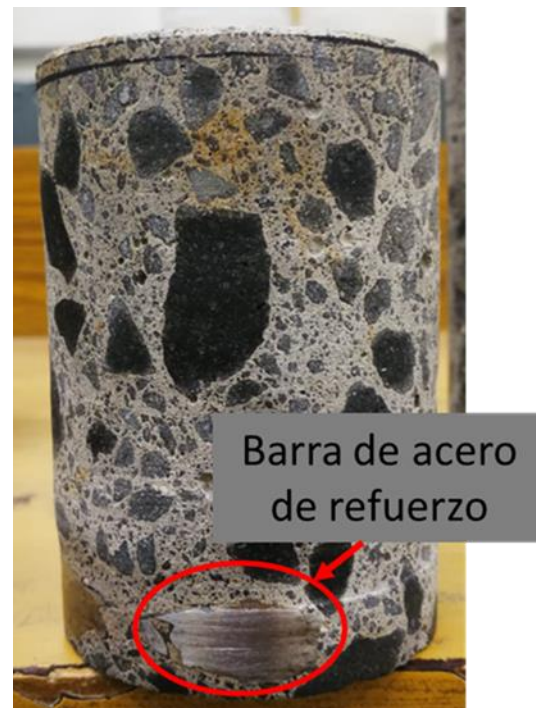
Figura 2. Ejemplo de núcleo inadecuado por poseer acero de refuerzo. Fuente: Laboratorio CETEC
