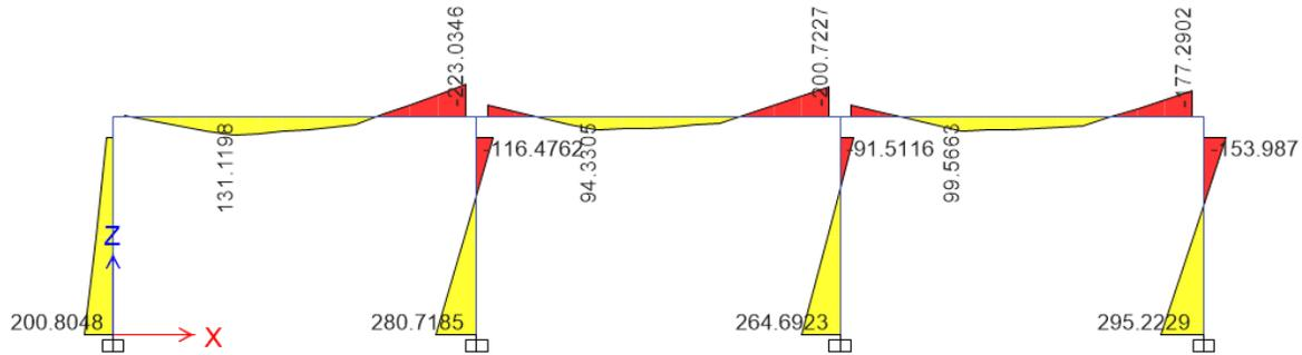
Figura A15. Máximos momentos flectores del modelo 1FLE; combinación 5. Fuente: Etabs, 2016.
