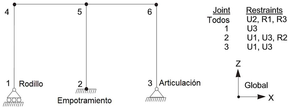
Figura A11. Ejemplos de restricciones en los apoyos para una estructura en dos dimensiones. Fuente: CSI Analysis Reference Manual, 2016.
