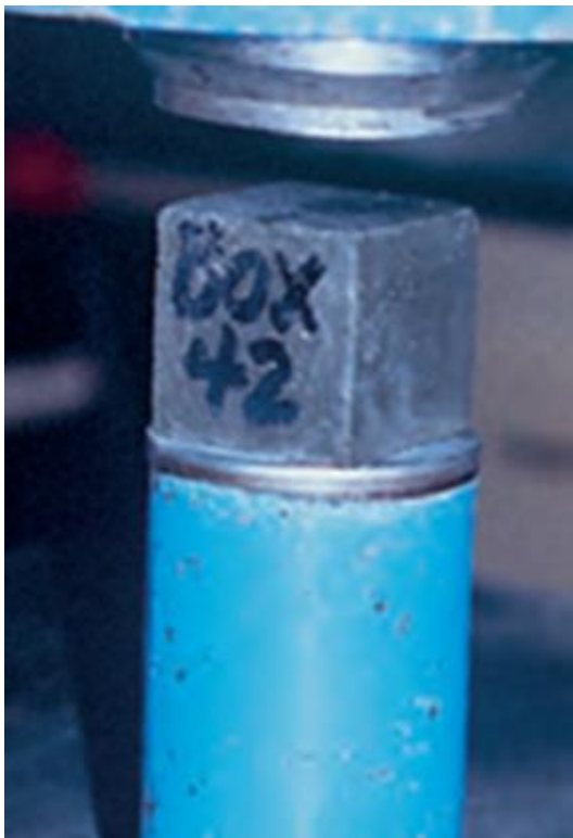
Figura 2. Ensayo de resistencia a compresión del cemento. Fuente: Portland Cement Association.
