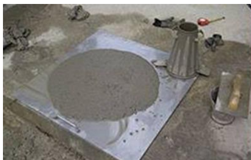
Figura 3. Equipo para determinar el flujo de asentamiento. Fuente ICCG.
