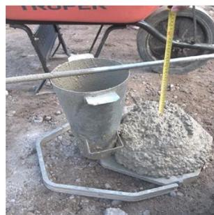
Figura 3. Revenimiento del concreto. Fuente: ICCG.
