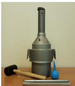
Figura 6. Aparato para determinar el contenido de aire. Método Volumétrico. Fuente: ICCG.
