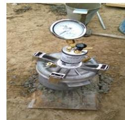
Figura 5. Contenido de aire por el Método de Presión. Fuente: ICCG.
