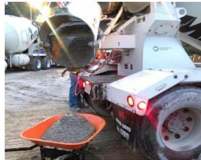
Figura 1. Muestreo de concreto de un camión mezclador. Fuente: ICCG.
