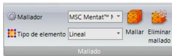
Figura 203. Ejecutar el mallado del sólido. Fuente: (CIVILFEM 2018).
