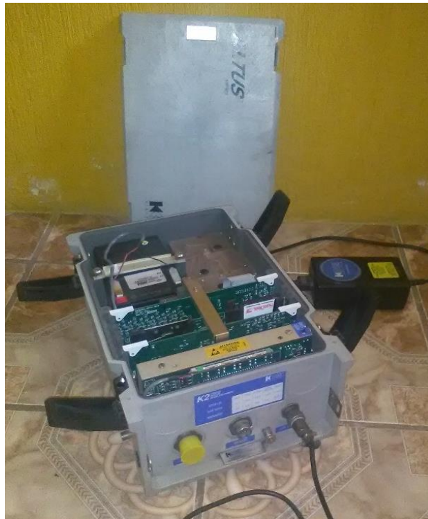
Figura 24. Acelerógrafo Altus Kinematics K2 propiedad de la División de Ciencias de Ingeniería CUNOC
