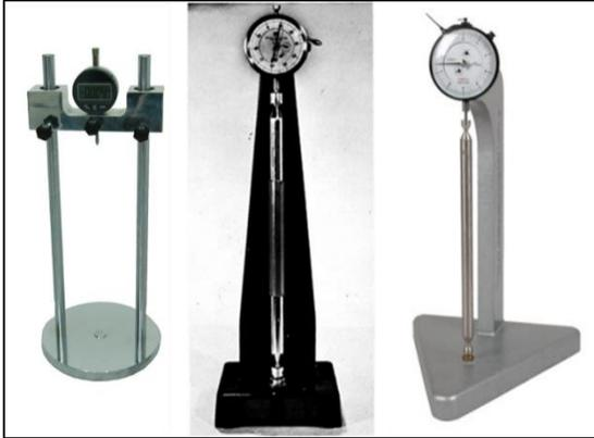
Figura 4. Diferentes modelos de Comparador de Longitud. Fuente: Humboldt Equipment Testing.
