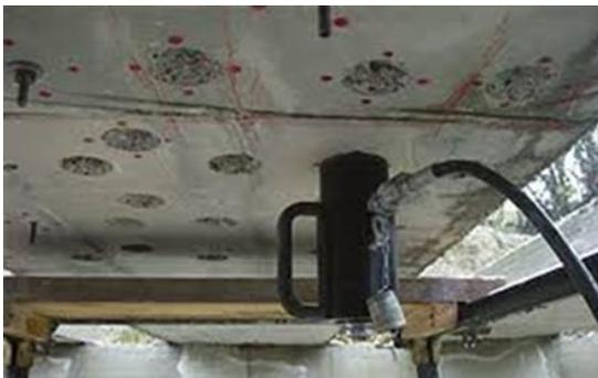
Figura 5. Aparato para ensayo de extracción por deslizamiento. Fuente: Equipos de ensayos no destructivos.
