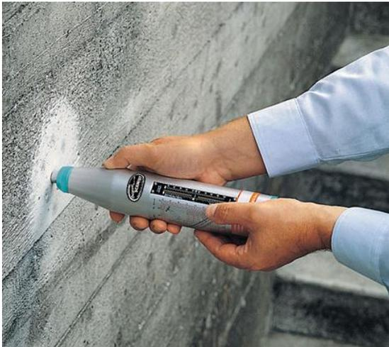
Figura 1. Martillo esclerométrico. Fuente: Equipos de ensayo no destructivos.
