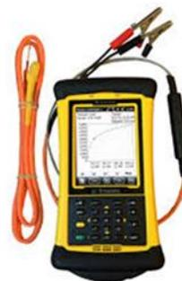
Figura 3. Aparato para ensayo de madurez.
