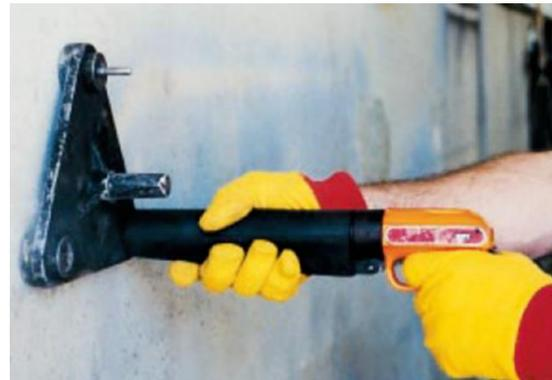
Figura 2. Aparato de penetración. Fuente: Equipos de ensayos no destructivos.
